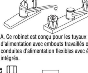
3 A. Ce robinet est conçu pour les tuyaux d'alimentation avec armoises travaillées ou les conduites d'alimentation flexibles avec écrous intégrés.
